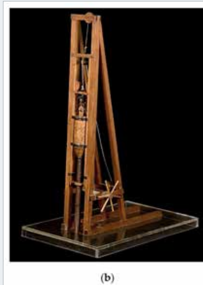
Obr. 7: Stroj na beranění Leonarda Da Vinci v Certero-Melia, 2020
