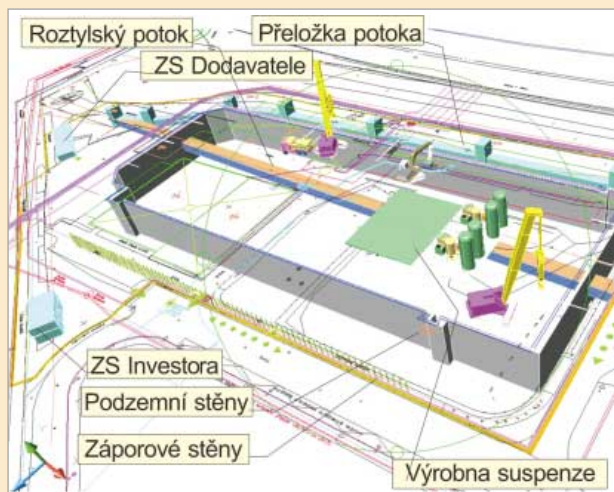
Stavební jáma pro obchodně-administrativní arál Roztyly, situace
