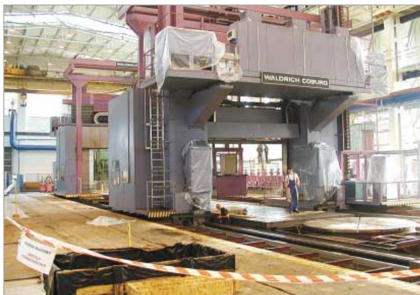
Obr. 1: Dvouportálové obráběcí centrum Waldrich-Coburg
