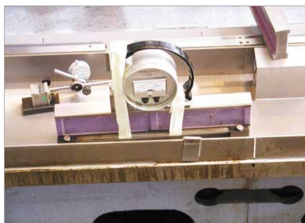
Obr. 9: Digitální vodováha NIVELTRONIK – zařízení pro měření nerovností portálových drah s přesností 0,001 mm
