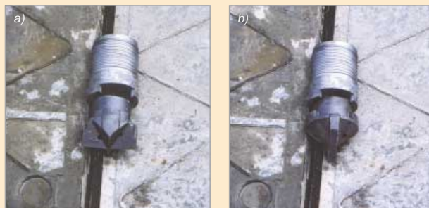
Křížová „ztracená“ korunka s přechodem (a) a jednobřítá „ztracená“ korunka s přechodem (b), který je nasazen na úvodní pažnici vrtné kolony
