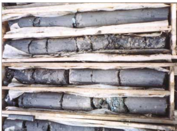
Obr. 2: Jádrové vrty, jimiž byla ověřena kvalita provedení sanace v oblasti vjezdového portálu
