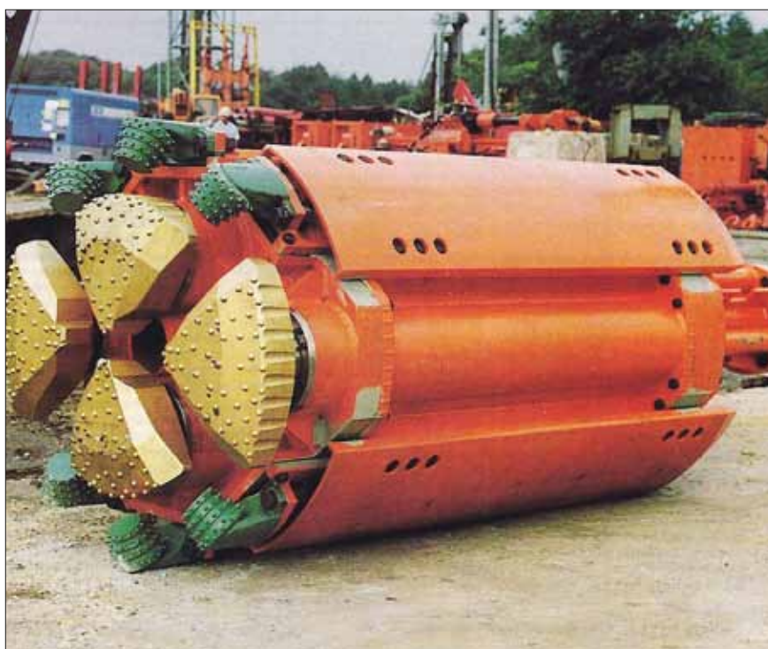
Obr. 13: Vrtný nástroj Mach R100 pro rotační vrtání sružením čtyř vzduchových ponorných kladiv pro vrtání ve zvětřalé žule s průměrem 1 m z roku 1988 (firma Tone Boring)
