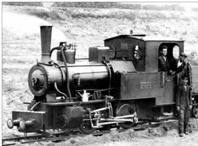
Lokomotivu o výkonu 60 koní na rozchod 760 mm, vyrobenou v roce 1928 firmou Henschel v Kasselu, si koupil podnikatel Ing. Secký. V červnu 1929 sloužila na regulaci Labe v úseku Lány–Srnojedy.
